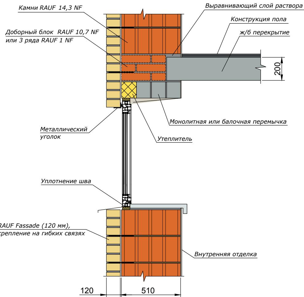
Устройство ж/б перемычки над проемом, наружная стена из крупноформатных камней RAUF Therme 14,3 NF (510 мм) с облицовкой кирпичом RAUF Fassade (120 мм)
