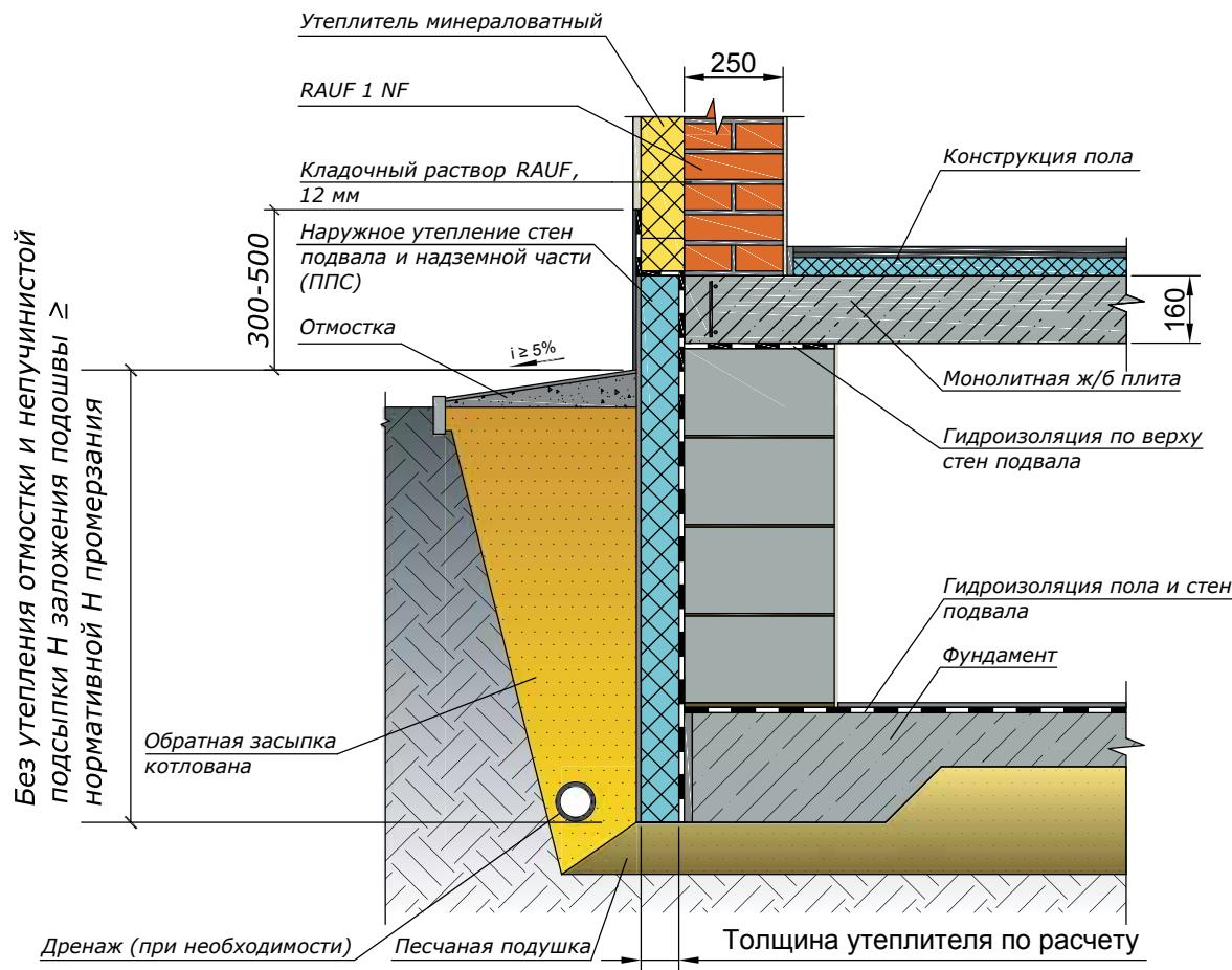
Наружная стена подвала из бетонных блоков, монолитное ж/б перекрытие,
