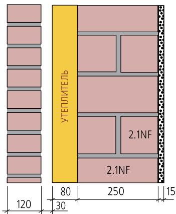
**Таким образом требуемая толщина стены из рядового пустотелого кирпича 1 НФ с облицовкой фасадным кирпичом составляет 1160 мм. Это эквивалентно стене из камня поризованного крупноформатного 14,3 НФ с облицовкой фасадным кирпичом, общей толщиной 640 мм.**
