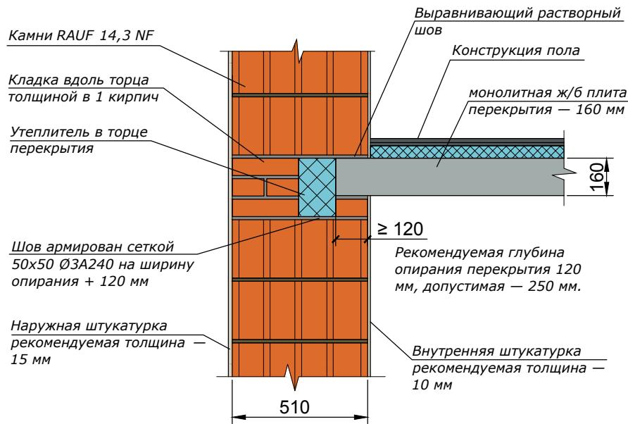
Вариант исполнения торца железобетонного перекрытия,
