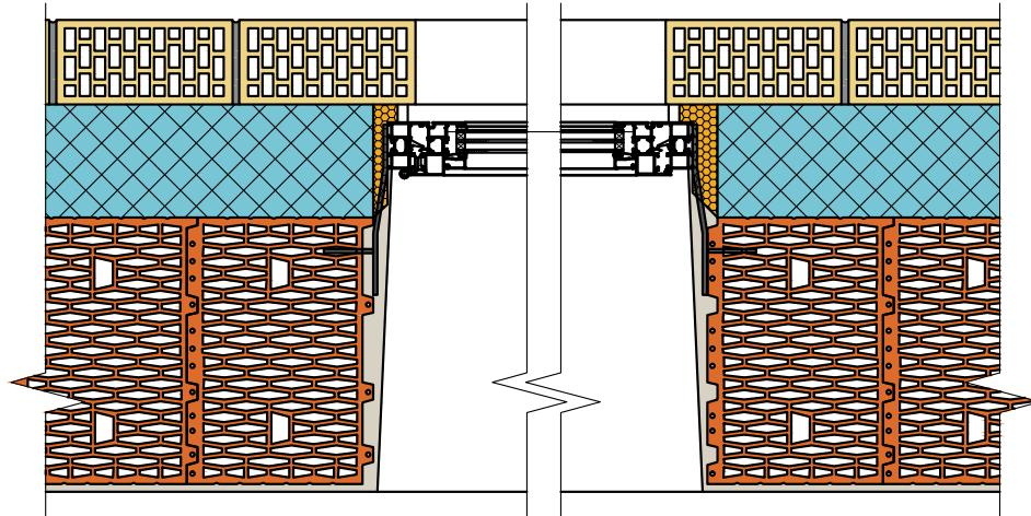
Установка окна в стену с наружным утеплением
