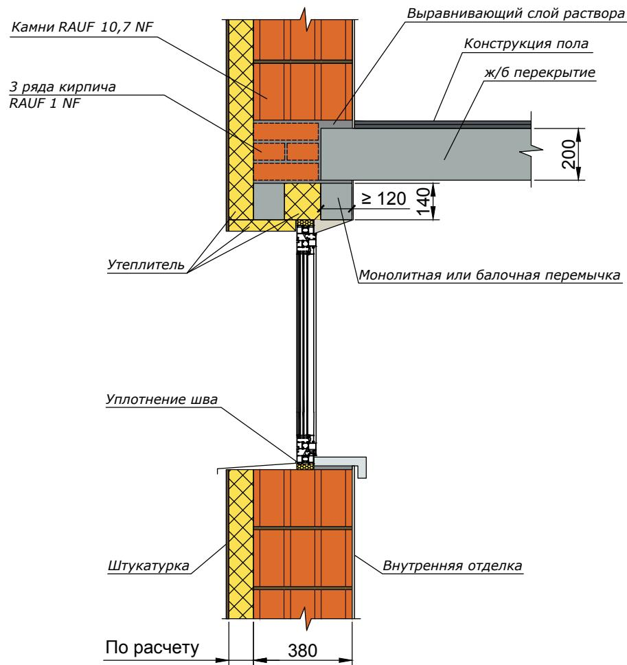
Устройство ж/б перемычки над проемом, наружная стена из крупноформатных камней RAUF Therme 10,7 NF (380 мм) с утеплением и штукатуркой
