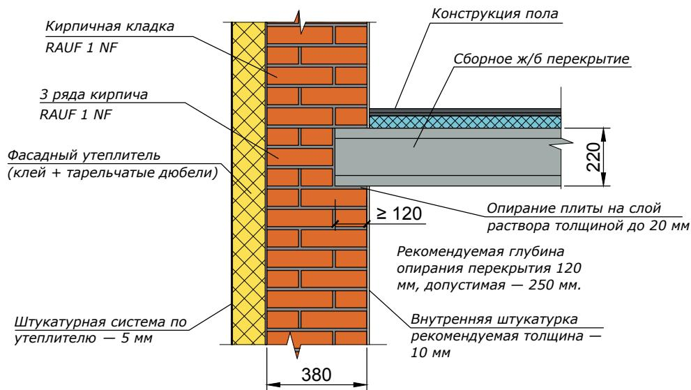
Пустотная плита перекрытия, наружная стена из крупноформатных камней RAUF Therme 1 NF (380 мм) с утеплением и наружной штукатуркой
