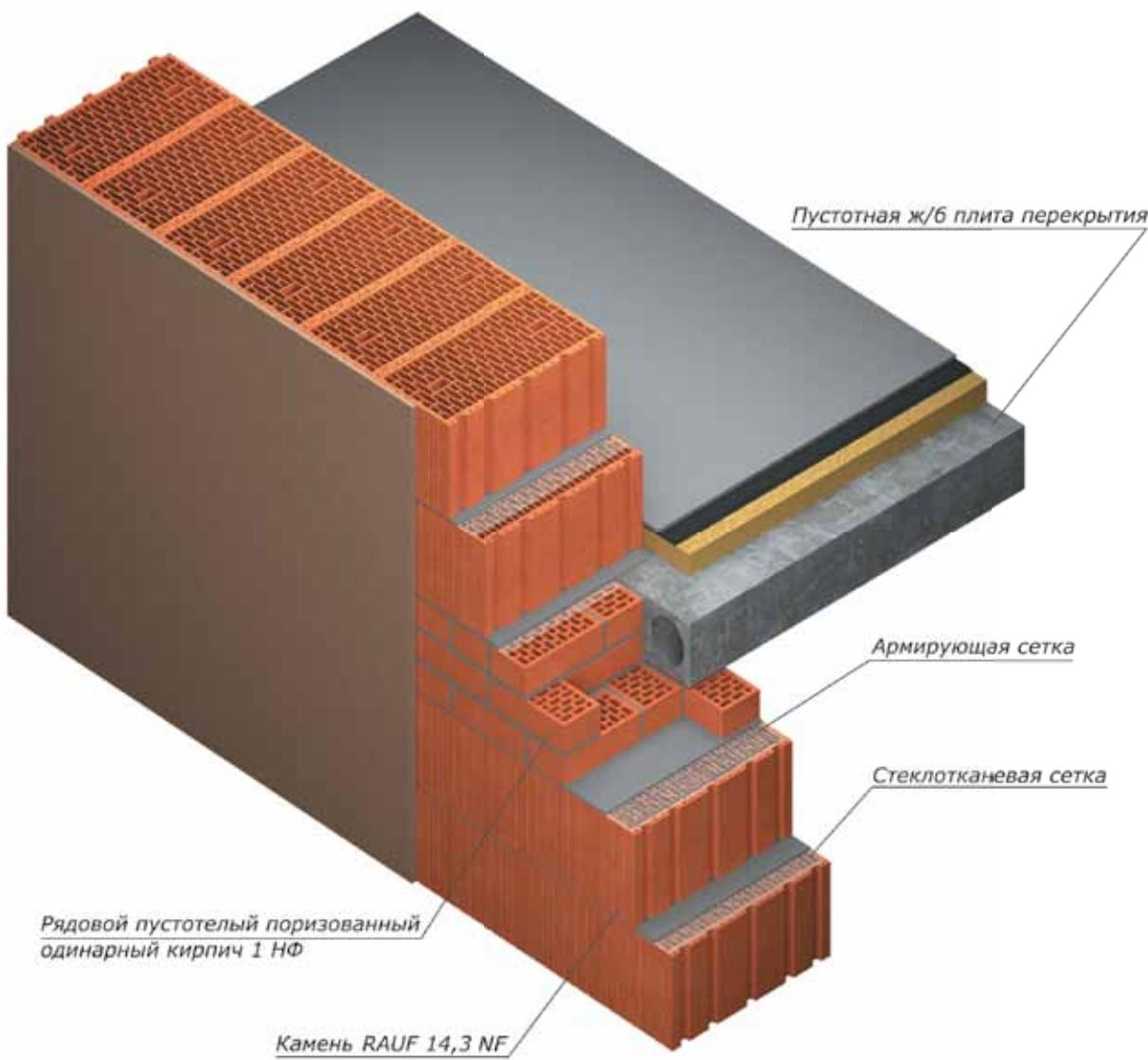
Опирание пустотной ж/б плиты на стену
