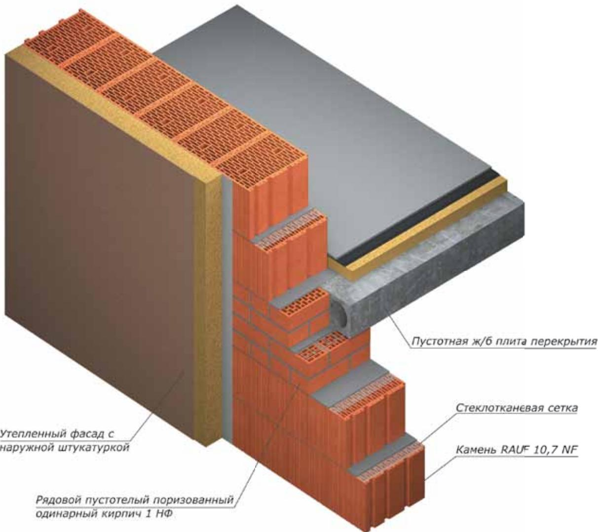
Опирание пустотной ж/б плиты на стену
