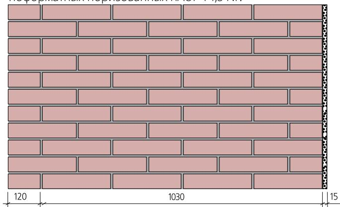
Кирпич рядовой пустотелый 1НФ =1,03 м,  $\lambda_b = 0,32 \text{ Вт}/(\text{м} \cdot ^\circ\text{C})$  ;
