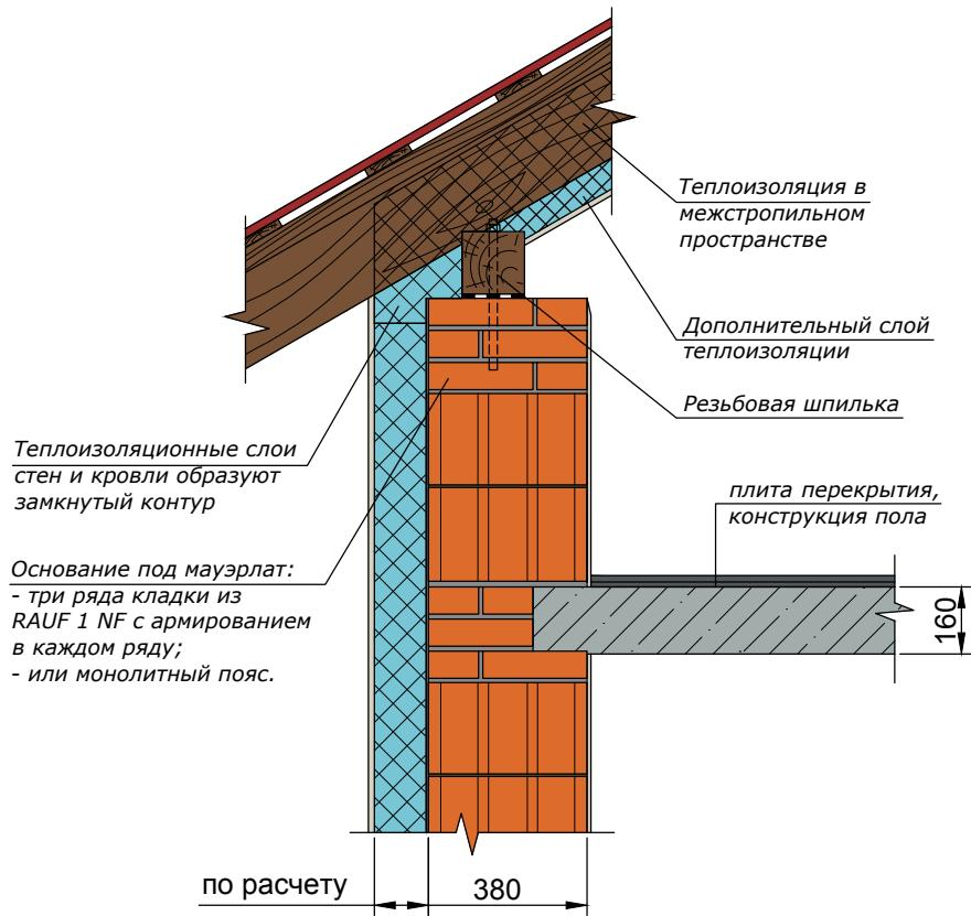
Скатная мансардная крыша, наружная стена из крупноформатных камней RAUF Therme 1NF (380 мм) с наружным утеплением и штукатуркой
