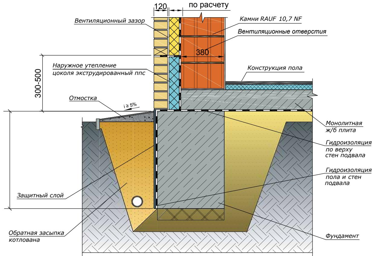
Монолитный ленточный фундамент, монолитный ж/б перекрытие, наружная стена из крупноформатных камней RAUF Therme 10,7 NF (380 мм) с утеплением и облицовкой кирпичом RAUF Fassade (120 мм)
