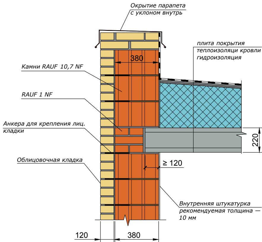
Плоская кровля с совмещенным покрытием по пустотной ж/б плите,
