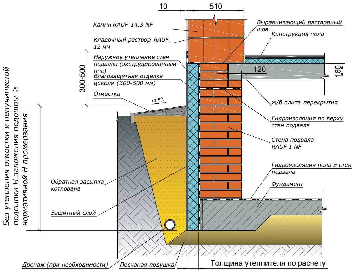
Наружная стена подвала из крупноформатных камней RAUF Therme 1 NF (380), монолитное ж/б перекрытие, наружная стена из крупноформатных камней RAUF Therme 14,3 NF (510 мм) с наружной штукатуркой
