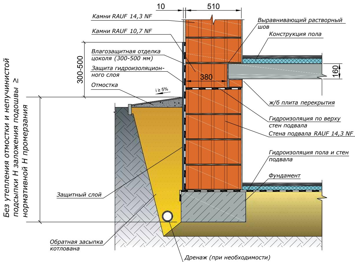
Наружная стена подвала из крупноформатных камней RAUF Therme 14,3 NF (510 мм),
