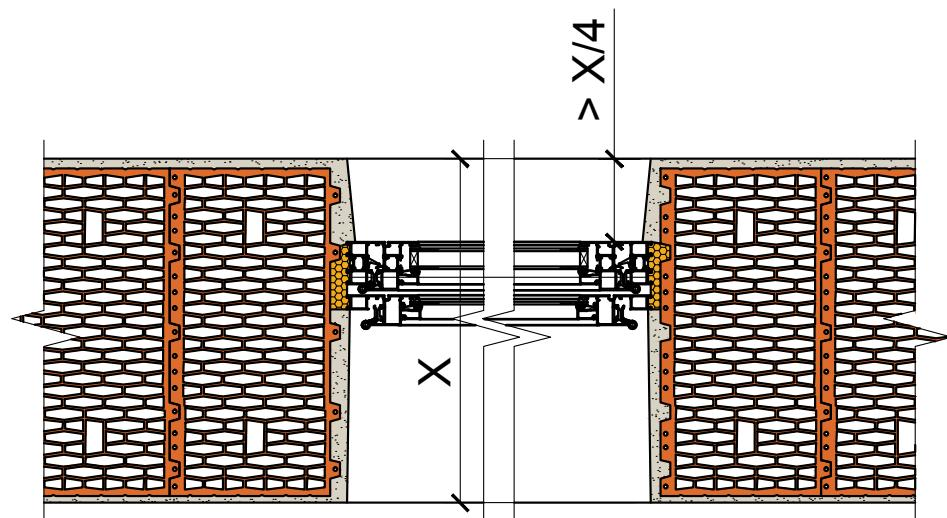
Установка окна в однородную оштукатуренную стену,
