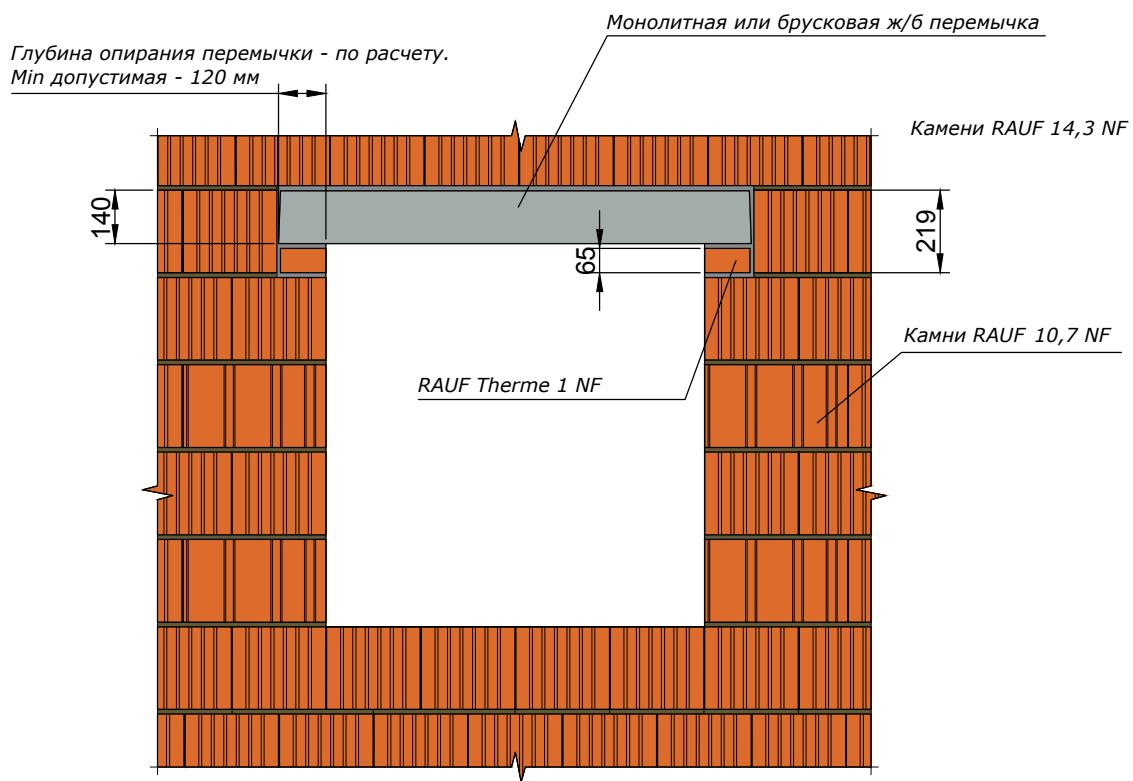
Устройство перемычек из крупноформатных камней RAUF Therme 14,3 NF
