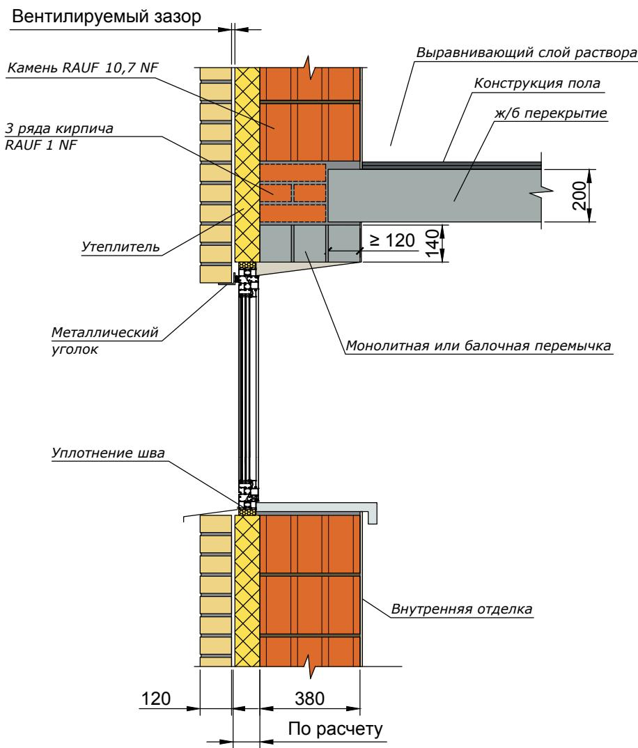
Устройство ж/б перемычки над проемом, наружная стена из крупноформатных камней RAUF Therme 10,7 NF (380 мм) с утеплением и облицовкой кирпичом RAUF Fassade (120 мм)
