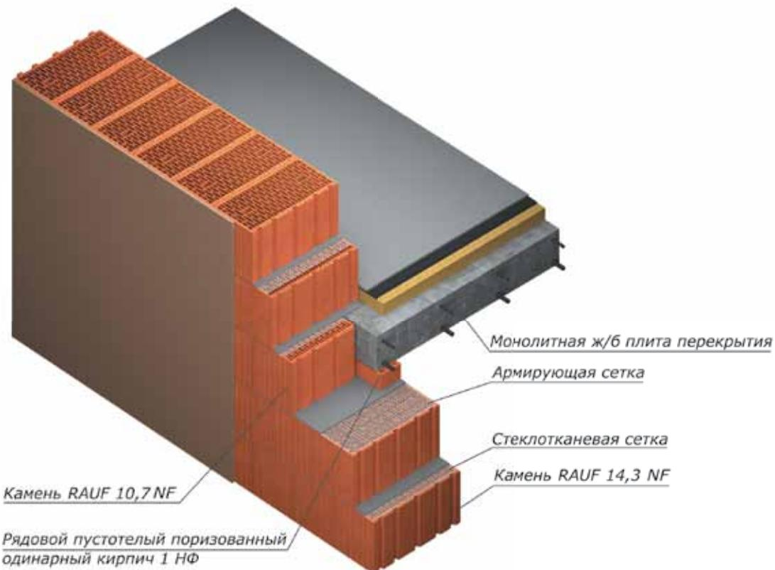
Опирание монолитной ж/б плиты на стену из крупноформатных камней RAUF Therme 14,3 NF (510 мм) со штукатуркой
