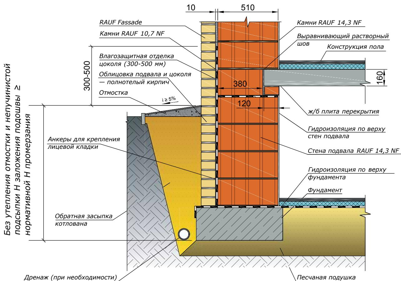
Наружная стена подвала из крупноформатных камней RAUF Therme 14,3 NF (510 мм), монолитное ж/б перекрытие, наружная стена из крупноформатных камней RAUF Therme 14,3 NF (510 мм) облицовкой кирпичом RAUF Fassade (120 мм)
