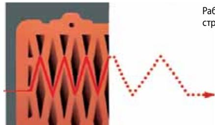
обретать свойства высокой тепловой инерции. Благодаря этому свойству интервал времени, в течении которого крайнее значение температуры с наружной стороны здания выравнивается с внутренней, существенно увеличивается.
