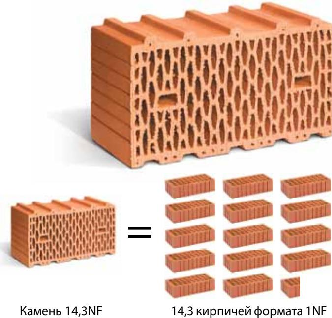
Камень 14,3 НФ крупноформатный поризованный является основным материалом при возведении стен домов в малоэтажном домостроении. Размер соответствует 14,3 кирпичей стандартного формата, однако в кладке один камень заменяет 12 кирпичей стандартного формата, с учетом растворных швов. Благодаря крупному формату и меньшему по сравнению с обычными кирпичами весу скорость ведения кладки из таких блоков увеличивается до 7 раз.
