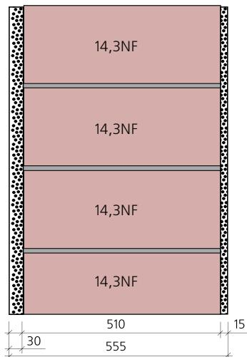
Для определения необходимой толщины стен производится расчет сопротивления теплопередаче кладки, утепляющего и облицовочного слоев. Вентилируемая облицовка в расчете не учитывается. По результатам расчета назначается необходимая толщина кладки, обеспечивающая  $R_{\text{comfort}}$ , либо  $R_{\text{norm}}$ .
