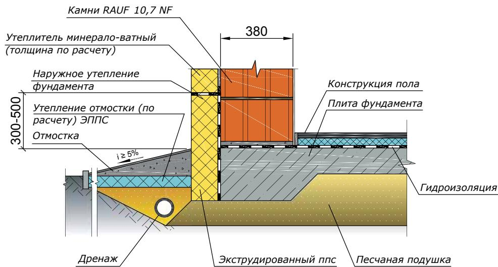
Мелкозаглубленный утепленный фундамент отапливаемого дома в виде ребристой плиты, стена из крупноформатных камней RAUF Therme 10,7 NF (380 мм) с утеплением и наружной штукатуркой
