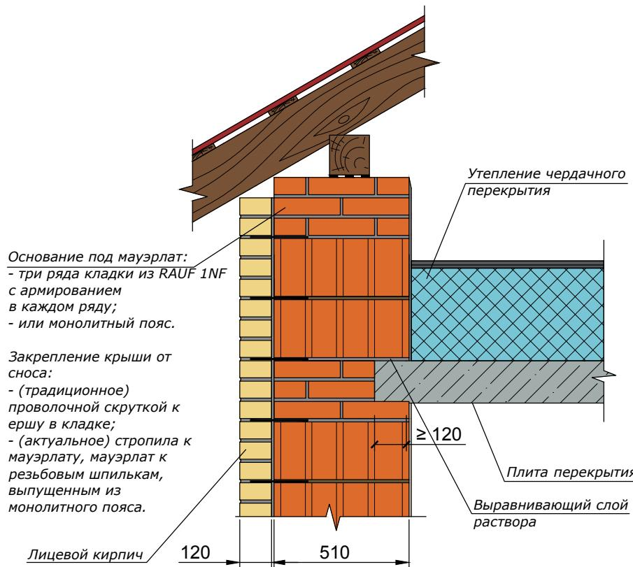
Скатная крыша с холодным чердаком, наружная стена из крупноформатных камней RAUF Therme 14,3 NF (510 мм) облицовкой кирпичом RAUF Fassade (120 мм)
