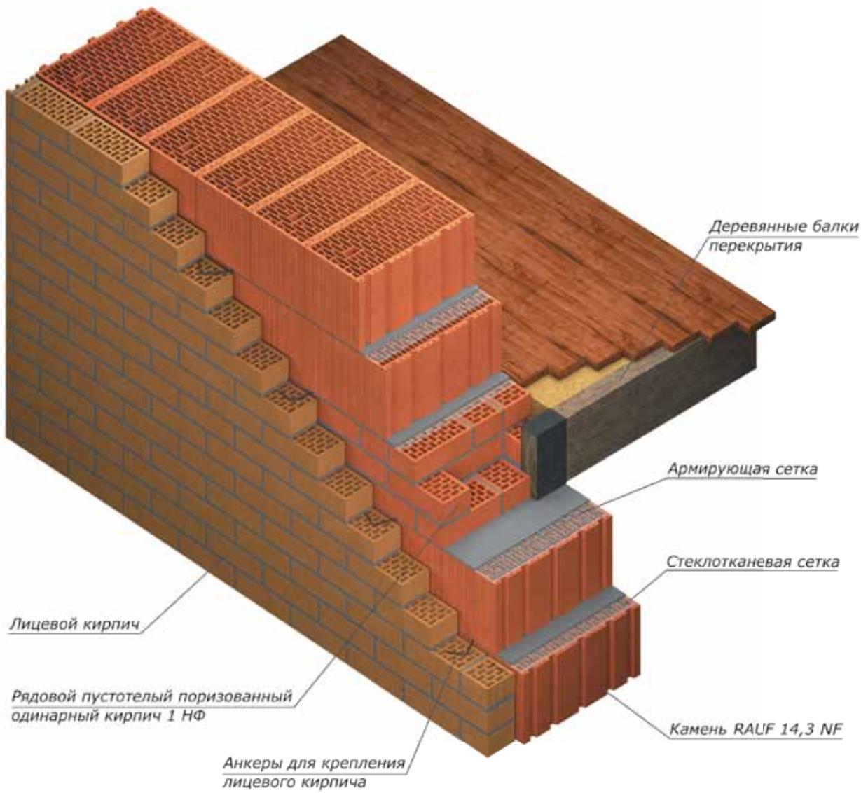
Опирание деревянных балок перекрытия на стену
