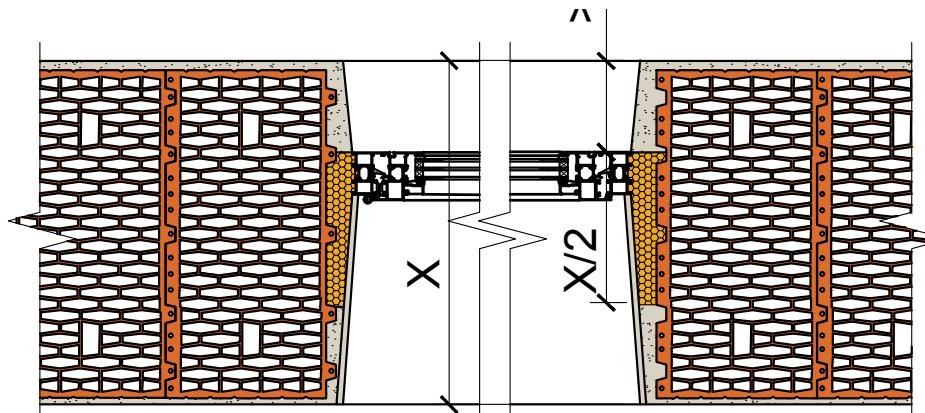
Установка окна в однородную оштукатуренную стену,
