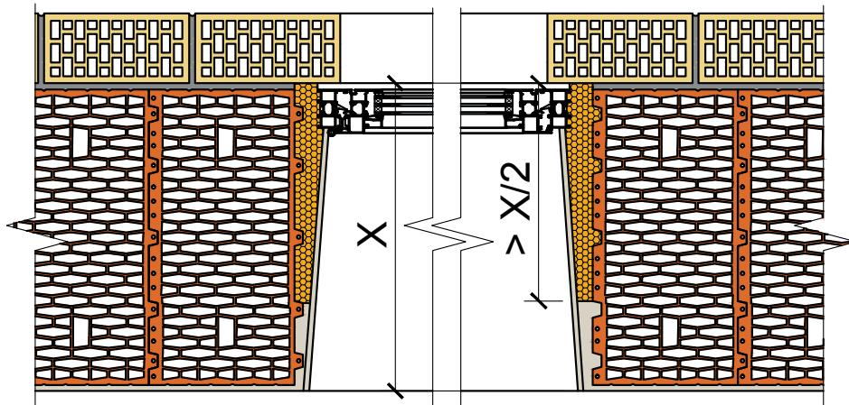
Установка окна в однородную стену с облицовкой кирпичом RAUF Fassade, оконная коробка шириной меньше 150 мм.
