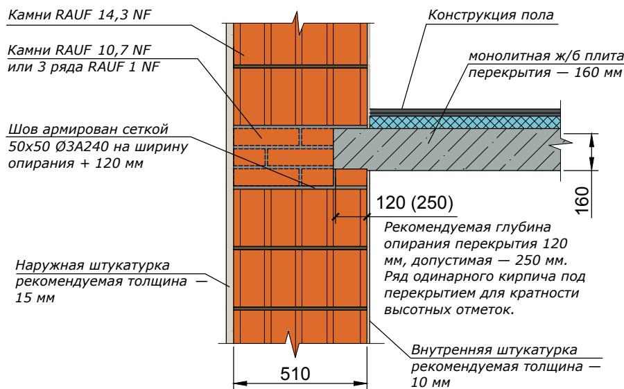
Монолитное железобетонное перекрытие, наружная стена из камней RAUF Therme 14,3 NF (510 мм) с наружной штукатуркой
