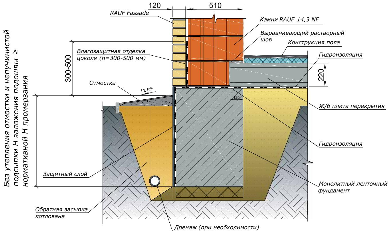
Монолитный ленточный фундамент, пустотная ж/б плита перекрытия, наружная стена из крупноформатных камней RAUF Therme 14,3 NF (510 мм) с облицовкой кирпичом RAUF Fassade (120 мм)
