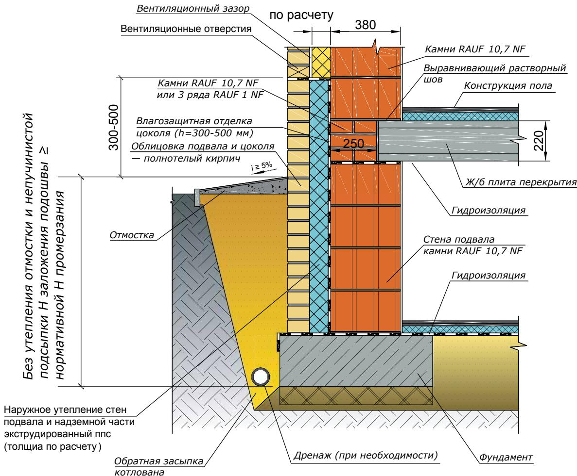
Наружная стена подвала из крупноформатных камней RAUF Therme 10,7 NF (380 мм), пустотная ж/б плита перекрытия, наружная стена из крупноформатных камней RAUF Therme 10,7 NF (380 мм) с утеплением и облицовкой кирпичом RAUF Fassade (120 мм)
