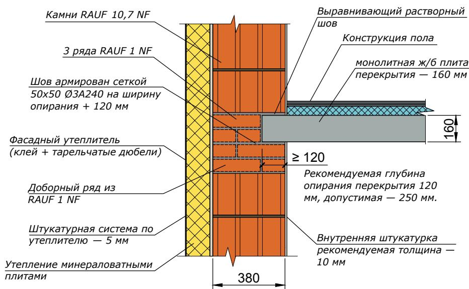
Монолитное ж/б перекрытие, наружная стена из крупноформатных камней RAUF Therme 10,7 NF (380 мм) с утеплением и наружной штукатуркой
