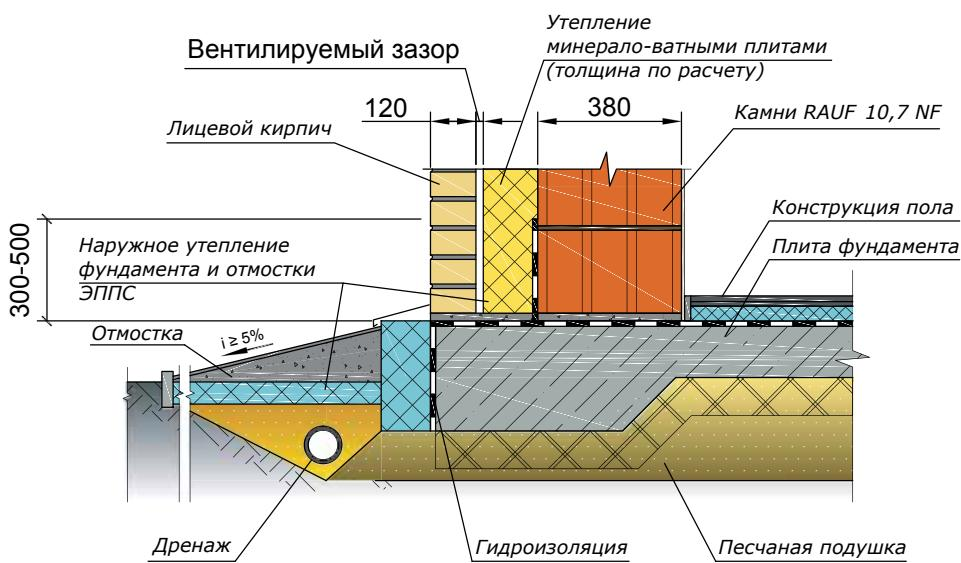
Мелкозаглубленный фундамент отапливаемого дома в виде ребристой плиты, стена из крупноформатных камней RAUF Therme 10,7 NF (380 мм) с утеплением и облицовкой кирпичом RAUF Fassade (120 мм)
