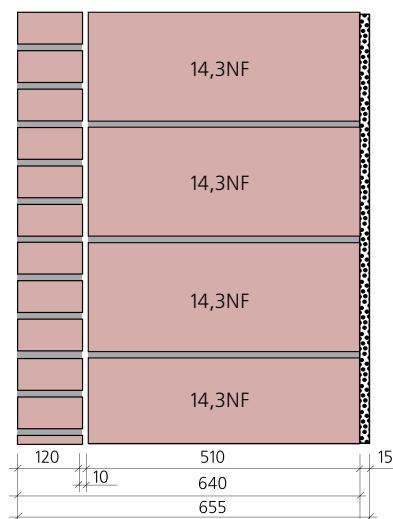
Камень крупноформатный поризованный RAUF 14,3 NF  $\delta = 0,51 \text{ м}$ ,  $\lambda_b = 0,185 \text{ Вт}/\text{м} \cdot {}^\circ\text{C}$ ;
