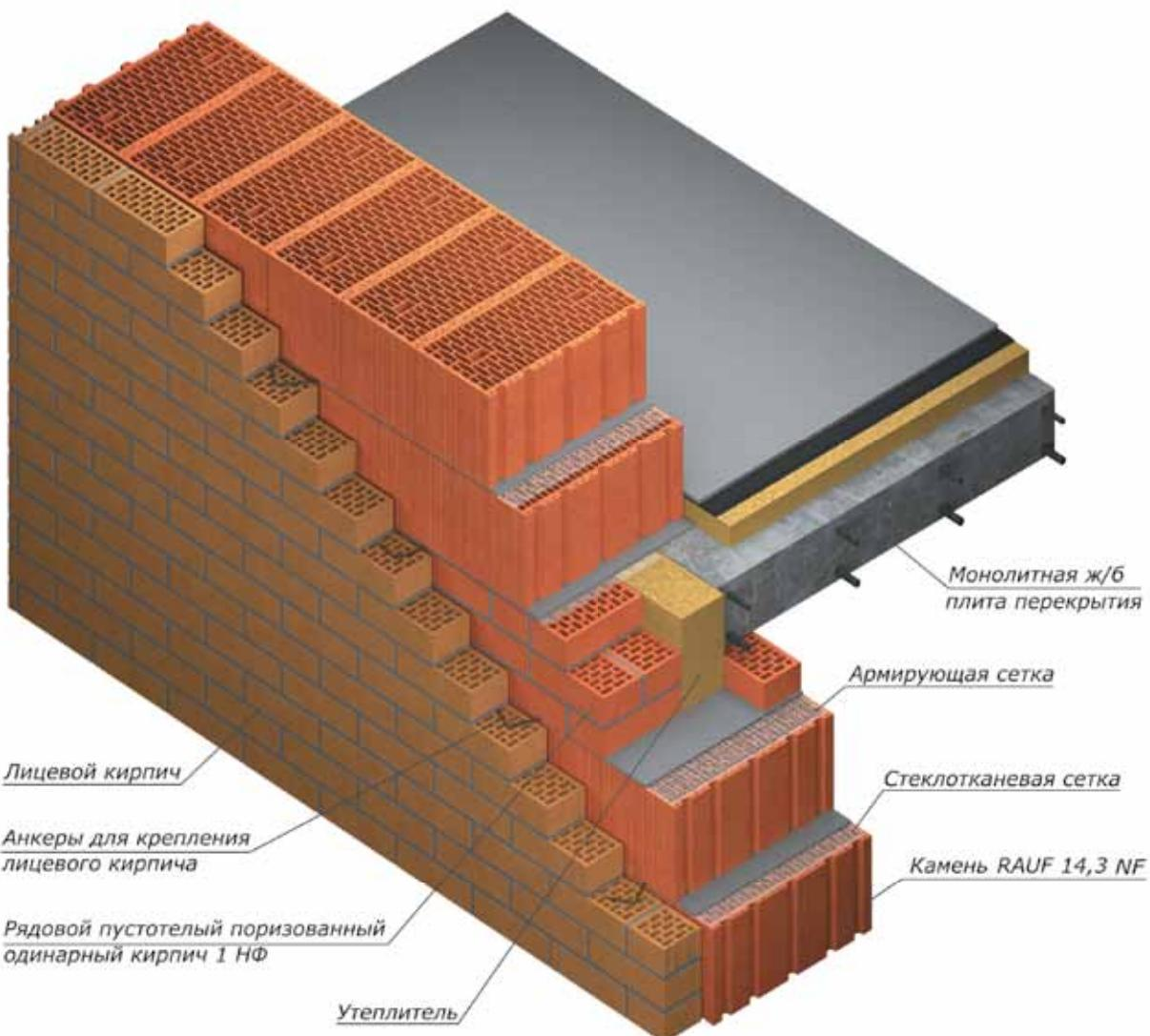
Опирание монолитной ж/б плиты на стену из крупноформатных камней RAUF Therme 14,3 NF (510 мм) с облицовкой кирпичом RAUF Fassade (120 мм)
