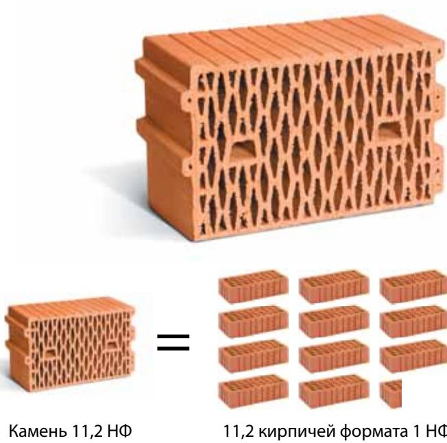
Камень RAUF 11,2 НФ выступает доборным элементом для выполнения проемов при возведении стен из камня RAUF 14,3 НФ, а также основным элементом при возведении внутренних несущих стен и перегородок толщиной 250 мм. Кроме того, камень 11,2 НФ используется для заполнения пространства нестандартных размеров при ведении кладки из камней 14,3 НФ, для чего он пилится и закрепляется в кладке между камнями 14,3 НФ по системе «паз-гребень».
