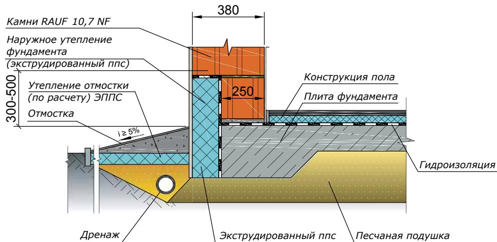
Мелкозаглубленный утепленный фундамент отапливаемого дома в виде ребристой плиты, стена из крупноформатных камней RAUF Therme 10,7 NF (380 мм) с утеплением и наружной штукатуркой
