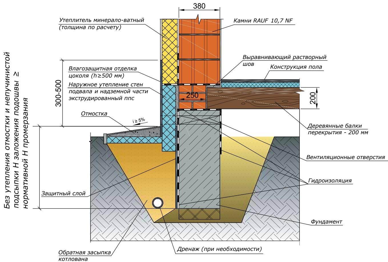
Монолитный ленточный фундамент, перекрытие по деревянным балкам, наружная стена из крупноформатных камней RAUF Therme 10,7 NF (380 мм) с утеплением и наружной штукатуркой
