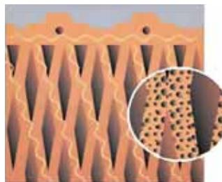
Работа пустот и поризованной структуры в блоке
